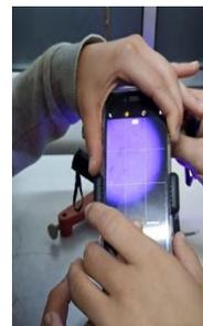
Fig. 1 - Microscópio com telemóvel acoplado. Iluminação com lanterna
