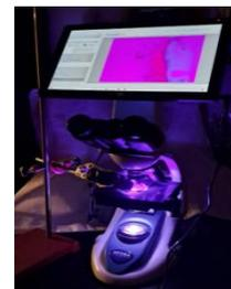
Fig. 2 - Microscópio didático (LED) com câmara digital e tablet integrados.
