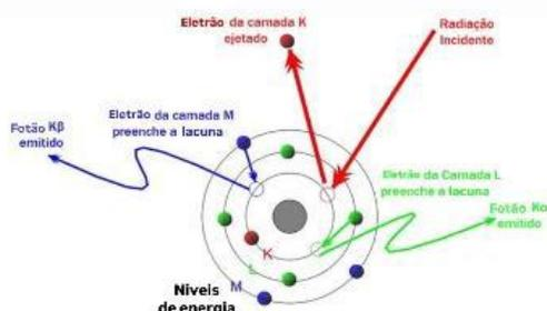
Figura 1 – Representação do fenómeno de fluorescência de Raios X
