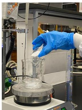
**Figura 2:** Adição de 3g de pululana a 100mL de água destilada (3%, m/v) à temperatura ambiente
