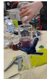
Fig. 5 – Filtração a baixa pressão
