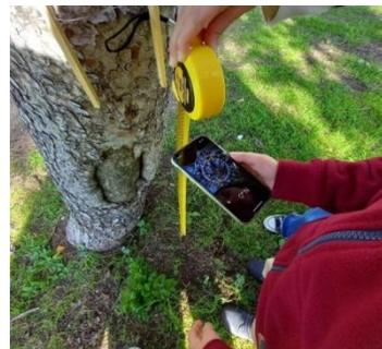
Figura 1. Medição de 80 cm da base com o *reticulum*.
