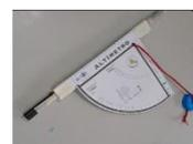
Fig. 4 – Altímetro construído com materiais de baixo custo
